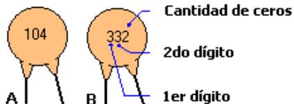
El valor del capacitor "B" es de 3300 pF (Picofaradio =  $\times 10^{-12}$  F) o 3,3 nF (Nanofaradio =  $\times 10^{-9}$  F) o 0,033  $\mu$ F (Microfaradio =  $\times 10^{-6}$  F). En el capacitor "A" debemos agregar 4 ceros después del 1er y 2do dígito. El valor del capacitor es de 100000 pF o 100 nF o 0,1  $\mu$ F.
